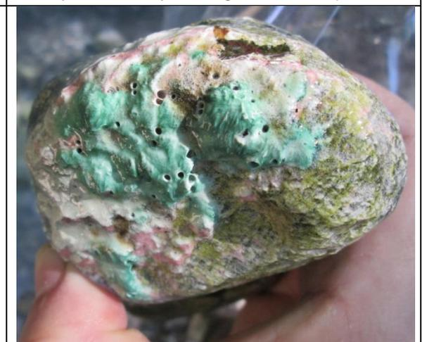
Ilustración 5 - Depósito de filamentos verdes sobre un canto. Este gel verde (RD-09B) está constituido por 81% de azufre y 13% de arcillas de tipo smectita o I/S, según el análisis por DRX.
