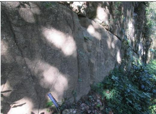
Ilustración 5 - Plano de fracturación sub-vertical orientado NNE-SSO, que afecta la tonalita masiva (plano continuo N10°E con pendiente de de 80° hacia el este).
