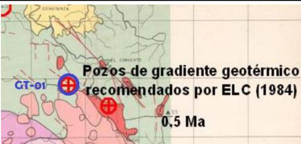
Ilustración 4 - Implantación del sondeo de gradiente térmico GT-1 en la formación Tiroo de edad Cretácica, según las conclusiones y recomendaciones de ELC (1984).
