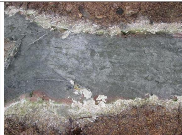
Ilustración 2 - Depósito blanco, reactivo al HCl (calcita +/- yeso), impregnando las orillas del canal de salida o bajo forma de fina película a la superficie del agua.
