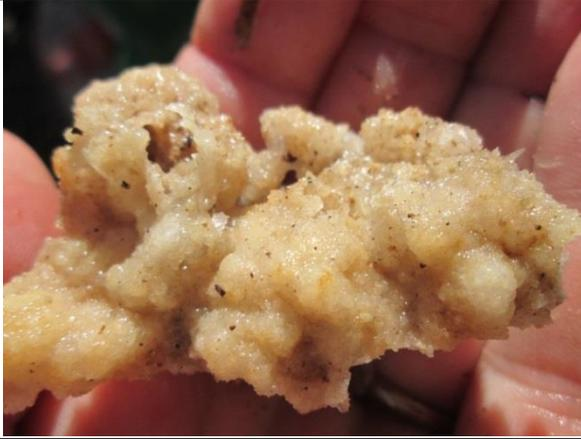
Ilustración 1 - Cavidad kárstica de la fuente recubierta esencialmente por sulfatos de calcio (92% de yeso y 5% de basanita) y 3% de sulfato de estroncio (celestita), según el análisis de la muestra RD-06A por DRX (tabl. 10). Fuerte olor a H<sub>2</sub>S en el medioambiente.
