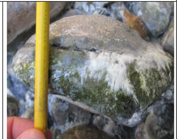
Ilustración 3 - Depósito de filamentos blancos sobre un canto. Este gel blanco (RD-09A) está constituido por 65% de azufre, 17% de arcillas de tipo smectita o I/S, y de 12% de yeso, según el análisis por DRX.
