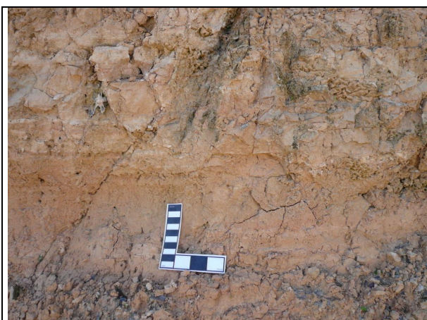
Foto 42 Pequeña falla subactual en los Limos pleistocenos; NE Hoja Puerto Escondido límite Hoja Duvergé (92MJ9189_3; Lat: 18,33678304; Long: -71,5402645)
