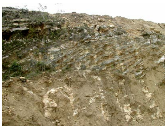
Foto 51 - Pie del vertedero de la presa de Maguaca : Calcarenitas bioturbadas (calizas arenosas con matriz arcillosa - arena de playa con clastos bioturbados y unos cuarzos); estratificaciones cruzadas a escala decimétrica (03PU9968: Lat.: 19.61615; Long.: -71.51441)
