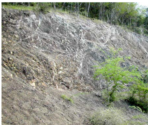
Foto 84 - (03PU9293) - Cantera de árido del Cerro Cayuco: brechas basálticas muy fracturadas por la ZFLE con vetillas blancas de caliche.
