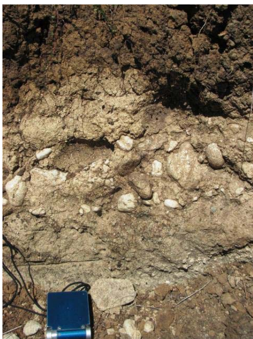
Fig. 148: Glacis aluvial o abanico de baja pendiente en sección vertical con cantos redondos de calizas en una matriz areno-arcillosa beige surmotanda por suelos orgánicos
