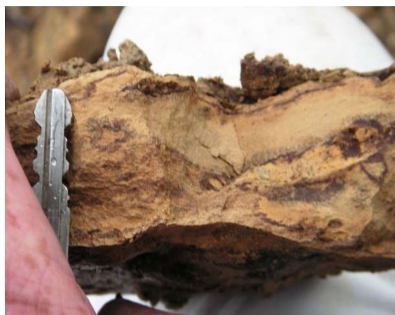
Fig. 98: Formación Mao - lutitas y siltitas: Lentejones semi dm de calizas finas caramelo dolomíticas con S0 horizontal ondulada y contornada.
