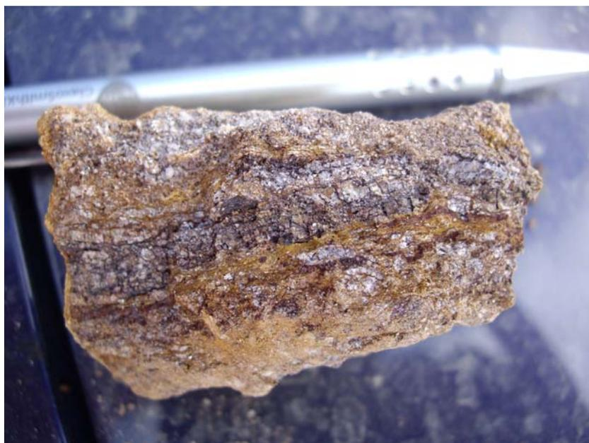
Foto 2.2. Aspecto del gossan bandeado y deformado correspondiente al indicio 60734003.
